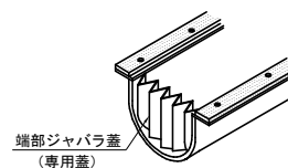
止水ゴムパッキン端部構造
